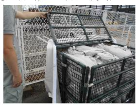
③ 前面枠ふたの留め具を外します。(固定金具を2か所外す。)
