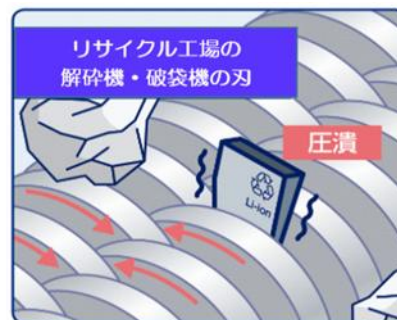
リサイクル工場での火災発生メカニズム
